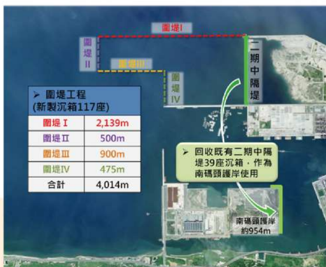
圖一 | 臺北港物流倉儲區第三、四期圍堤新建工程施作工項
